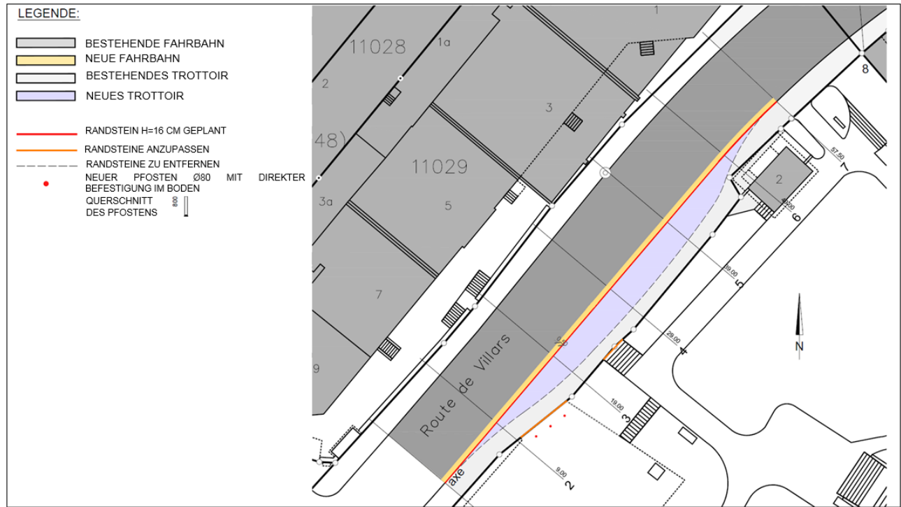
Abbildung 1: Verlegung der Bushaltestelle auf die Fahrbahn
